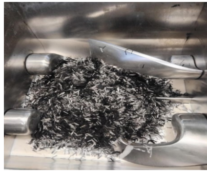
Préparation de BMC avec fibres de carbone recyclées:
